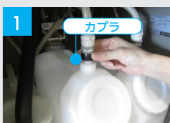
1 カプラを軽く引き上げ給水タンクから外す。
