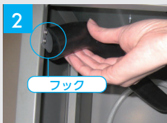
2 外した排水ホースの先端をキャビネット左上部のフックに固定する。
