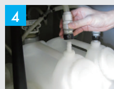
4 給水タンクに水を補充し、キャビネットにセットする。カプラを取付ける際は「カチッ」と音がするまで押し込み接続すること。
