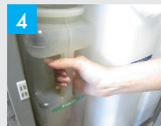
4 排水タンクを台に取付け排水ホースを戻す。
