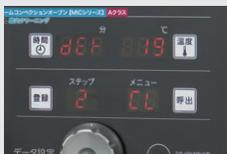
2 工程終了後にブザー音が鳴り、クリーニング運転が終了します。ミトンを着用して、ガラス扉を少し開き、水蒸気、熱気を放出させます。
