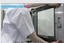
2 扉露受け皿をふきます。汚れが落ちにくい場合は、扉露受け皿を外し、市販のブラシを使って中性洗剤で汚れを落としてください。
