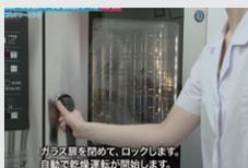
5 操作パネルの運転ボタンを長押しします。ミトンを着用して、ガラス扉を少し開き、水蒸気、熱気を放出させ、その後ガラス扉を開きます。
