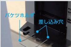
5 バケツ等の容器をバケツホルダの上に載せ、注出ボタンを1回押し、注出ボタンを押して氷を注出し、ストッカー内部にある水を全て注出させます。
