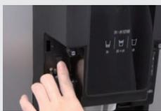
2 操作パネル内の「氷」・「氷+水」・「水」ボタンを同時に3秒以上長押しし、氷連続注出モードに切り替えます。
