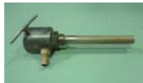
使用を取り止めた吐出パイプ
