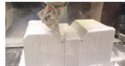
トリミングマシンにより切れ目が入った状態
